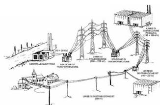
Struttura Generale Sistema Elettrico
