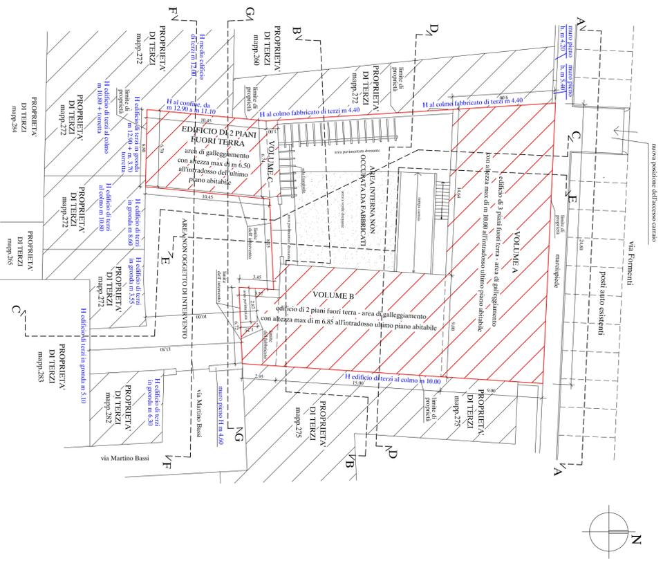
Schema planimetrico di progetto con linee di sezione - scala 1:200
